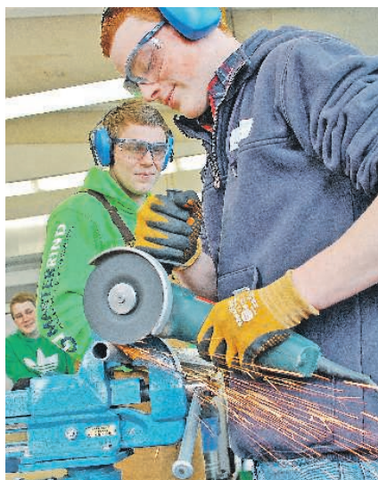
Hier sprühen die Funken: Malte Krondak aus Pattensen und Johannes Koch aus Stade (v. l.) kürzen die Gelenkwelle.
